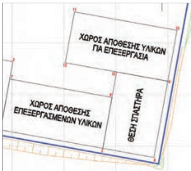
Εικόνα 3.4.: Τυπική διάταξη χώρου κατάληψης σπαστηριοτριβείων (άνευ κλίμακας)
