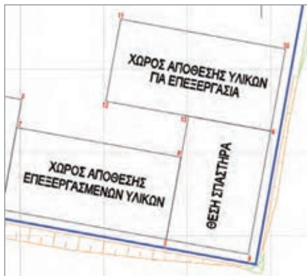
Εικόνα 6.3.: Τυπική διάταξη χώρου κατάληψης σπαστηριοτριβείων (άνευ κλίμακας)
