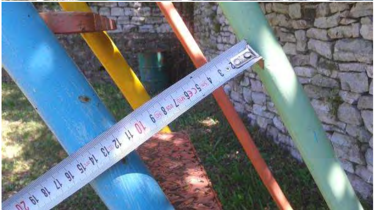
Εικόνα 19: Παγίδευση κεφαλής/λαιμού στην τσουλήθρα.
